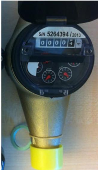
Bei diesem Zählertyp kommt es vor, dass die letzte Ziffer nicht vollständig angezeigt wird. In diesem Fall ist die letzte Ziffer auf eine ganze Zahl zu runden.
