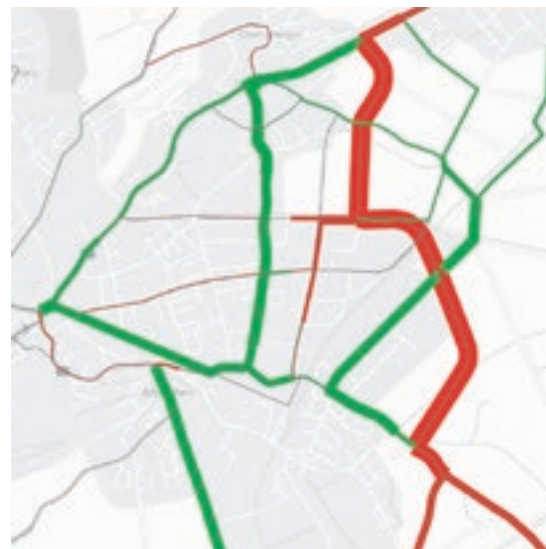
Abbildung 2: Verkehrsverlagerungen mit der Ostumfahrung (Rot: Verkehrszunahme in beide Richtungen, Grün: Verkehrsabnahme in beide Richtungen)
